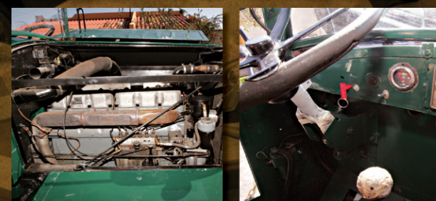
DETALLES ÚNICOS: Chavelo no tiene cardán, sino una cadena; su tablero de controles es elemental, y originalmente carecía de luces de vía. Su motor es de seis cilindros en línea.
